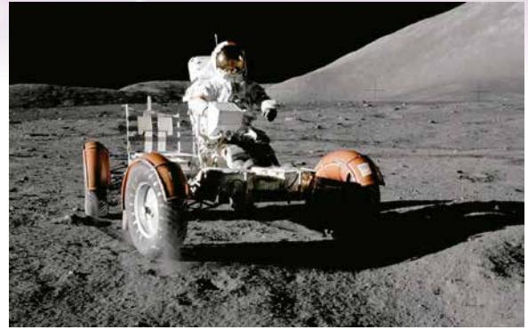
Misión Apolo 17. Lunar Roving Vehicle (LRV) era un vehículo todo terreno empleado por los astronautas de las misiones Apolo 15, 16 y 17 en sus desplazamientos por la superficie lunar.
